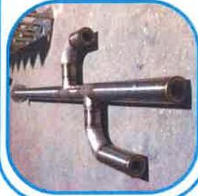
Todos los elementos soldados se realizan mediante soldadura TIG. Con la que obtenemos unos acabados más óptimos.
